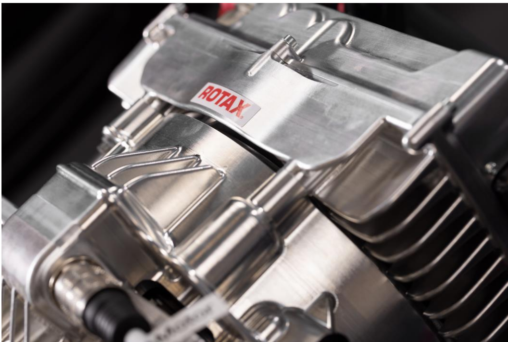
Das neue Rotax E10 48 V Hochleistungs-Renn-Elektroantrieb für Karts © 2022 copyright BRP-Rotax
